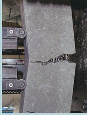
JSCE G 552-1999 曲げタフネス試験
